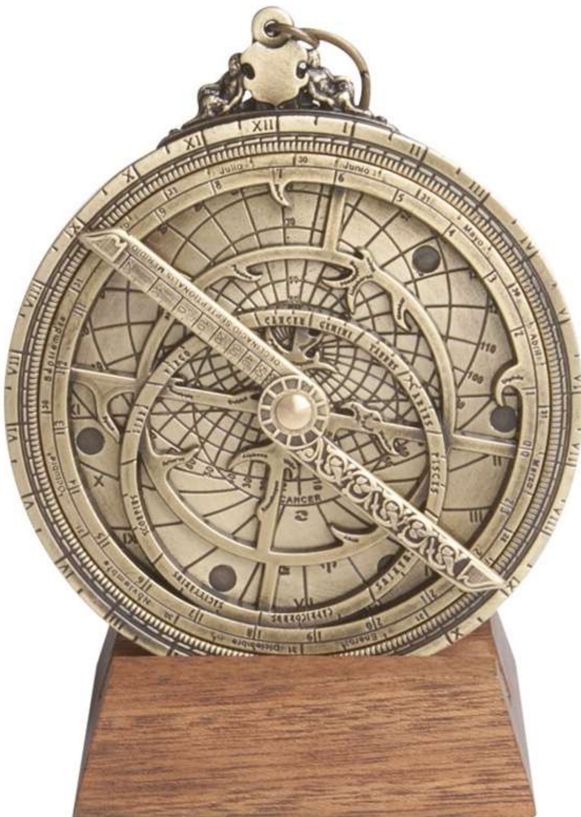
Obrázok: Tento astroláb od firmy Hemisferium (Madrid, Španielsko) má priemer 10 cm a je plne funkčný. Mapa oblohy pochádza z 21. storočia. Bude nám slúžiť ako príklad modernej repliky historického astrolábu.
